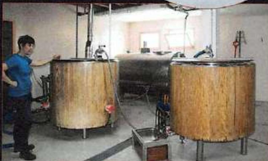
Avant l'ajout du houblon, il est nécessaire de retirer la mousse provoquée par le débet de l'ébullition.
